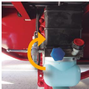
Afin de lever le toit de la carrosserie, activer la pompe hydro-pneumatique située sur le châssis à hauteur des béquilles d'appui
