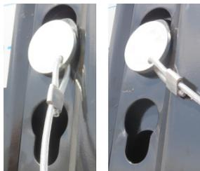
Les poteaux centraux ont deux types d'appuis pour les butées de sécurité plots de réglage.
