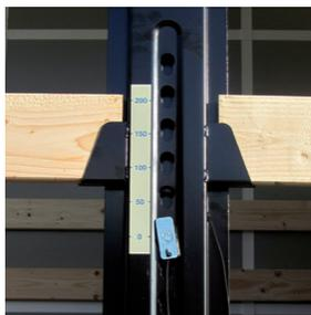
Le système d'élévation Multipunto Lecitrailer permet d'exploiter le véhicule avec la carrosserie relevée de 0 à 200 mm, avec possibilité d'ajuster la hauteur des butées tous les 50 mm.
