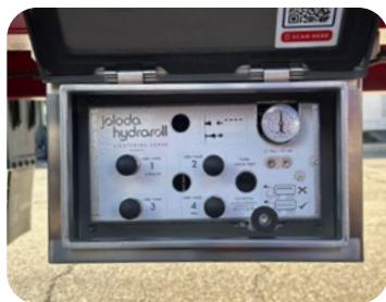
Control box con interruptor de encendido luces y sistema de control de los 4 bloques de railes
