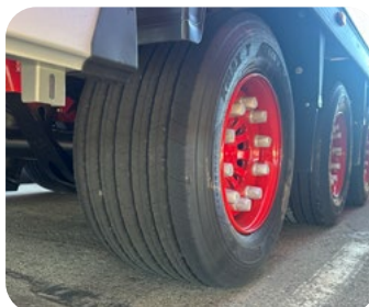
Cuello embutido y rueda de 19,5 pulgadas para garantizar la máxima capacidad de carga
