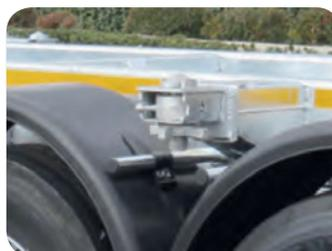
Opção: Twistlock adicional, rebatível, que permite a carga de um contentor de 20' avançado, aumentando a distribuição de pesos no eixo motriz do trator.
