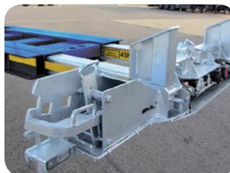
Opção: Extensão frontal dianteira para carga de contentores 45' e caixas móveis dentro dos máximos legais permitidos (sem autorização especial para transporte). Deslizamento de extensão guiado por rolamentos e placas de Teflon. Conjunto completo de extensão galvanizado para garantir a sua conservação.
